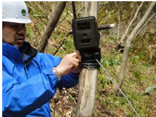
センサーが感知し、写真のカメラが撮影・メールで状況を知らせる
