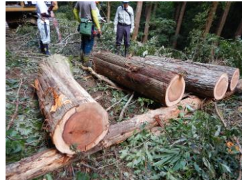
1番玉(左端)2番玉(右写真)を調査、変色し材質が低下
