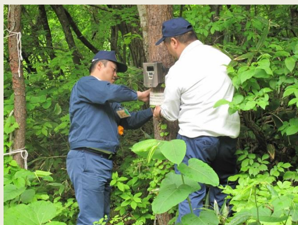
センサーカメラの設置方法
