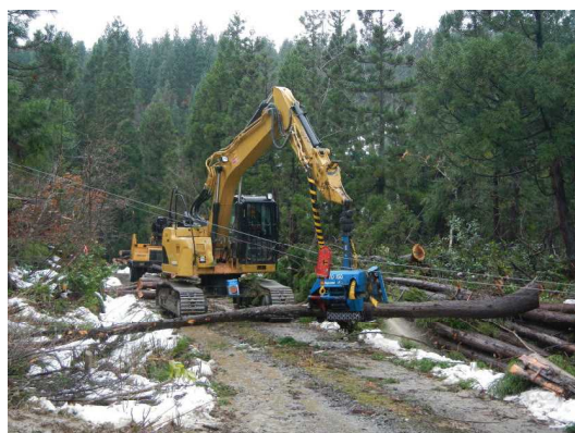
プロセッサによる枝払及び玉切り状況
