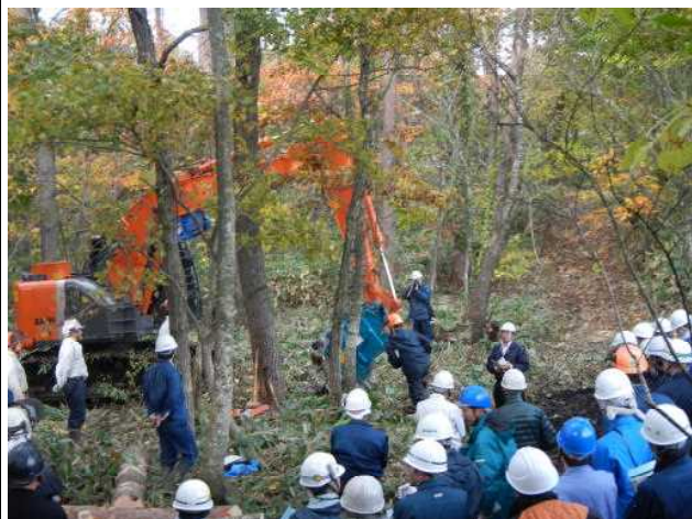
イワフジ工業バケットグラップル による改良作業
