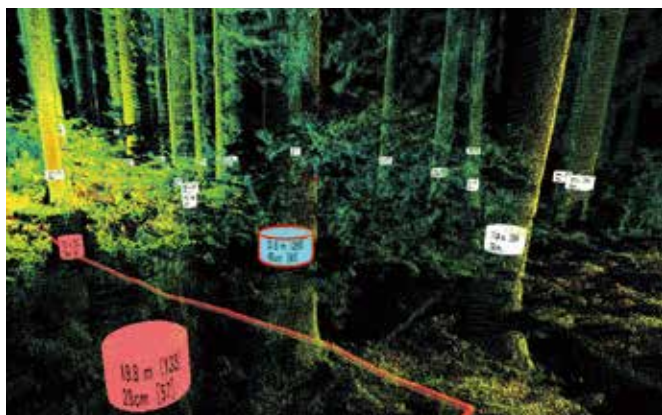
アウルはPC上で林木の形状や配置、地形などが確認できる
