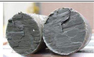
(右)写真2. 破断面付近(深さ153m)
