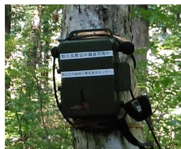
写真1 録音機材設置状況
