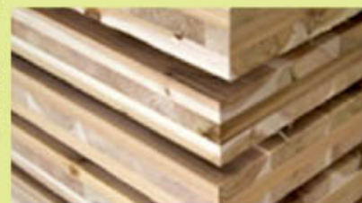
CLT材の断面
