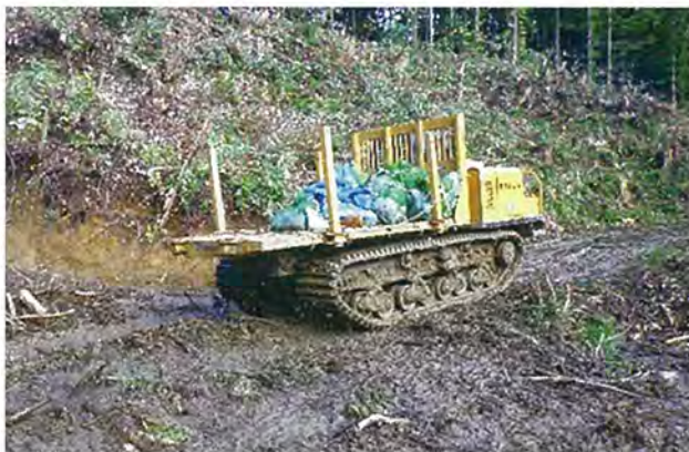
重機による苗木の運搬
