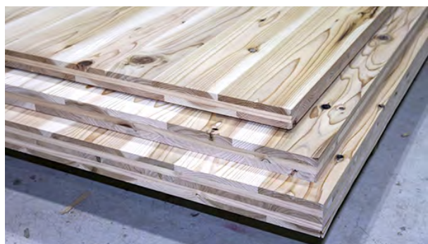
写真 薄物CLT 上:3層プライ30mm、 中:同36mm、右:5層5プライ50mm
