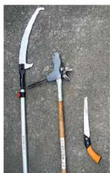
使用した用具（左から 高枝切鋸、枝打ち鋏、手鋸）
