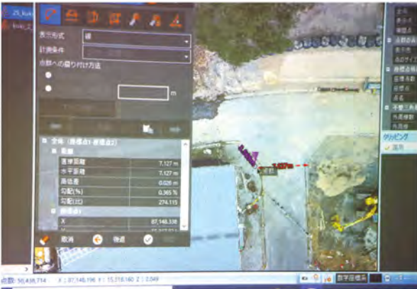
写真6 点群データ処理・計測ソフトを用いての実測値との検証
