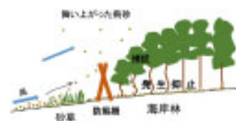
図1 観測地の海岸林とその周辺の飛砂移動形態の模式図
