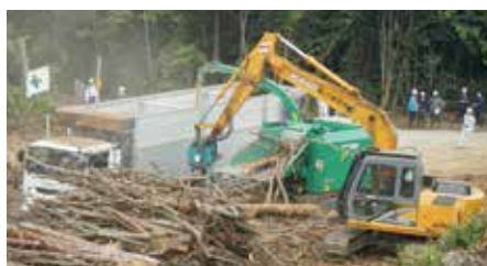
移動式チップパーでの粉碎・積込の様子
