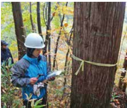
幹の打音速を測定
