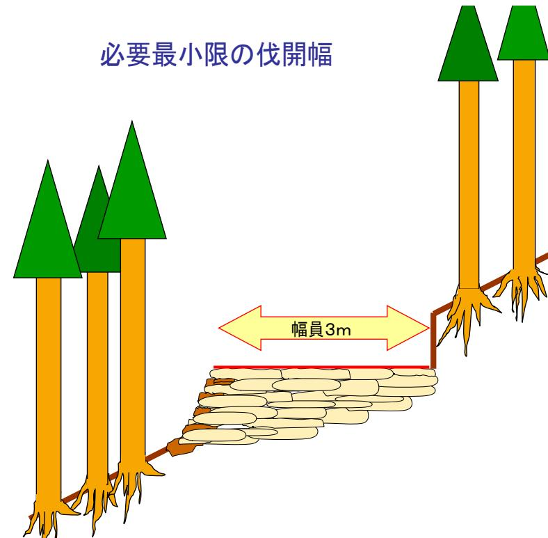
○幅員は3mまでとする。但し、林業機械を用いた作業の安全性、作業性の確保の観点から、当該作業を行う区間に限って、0.5m程度の余裕を付加することができるものとする。
