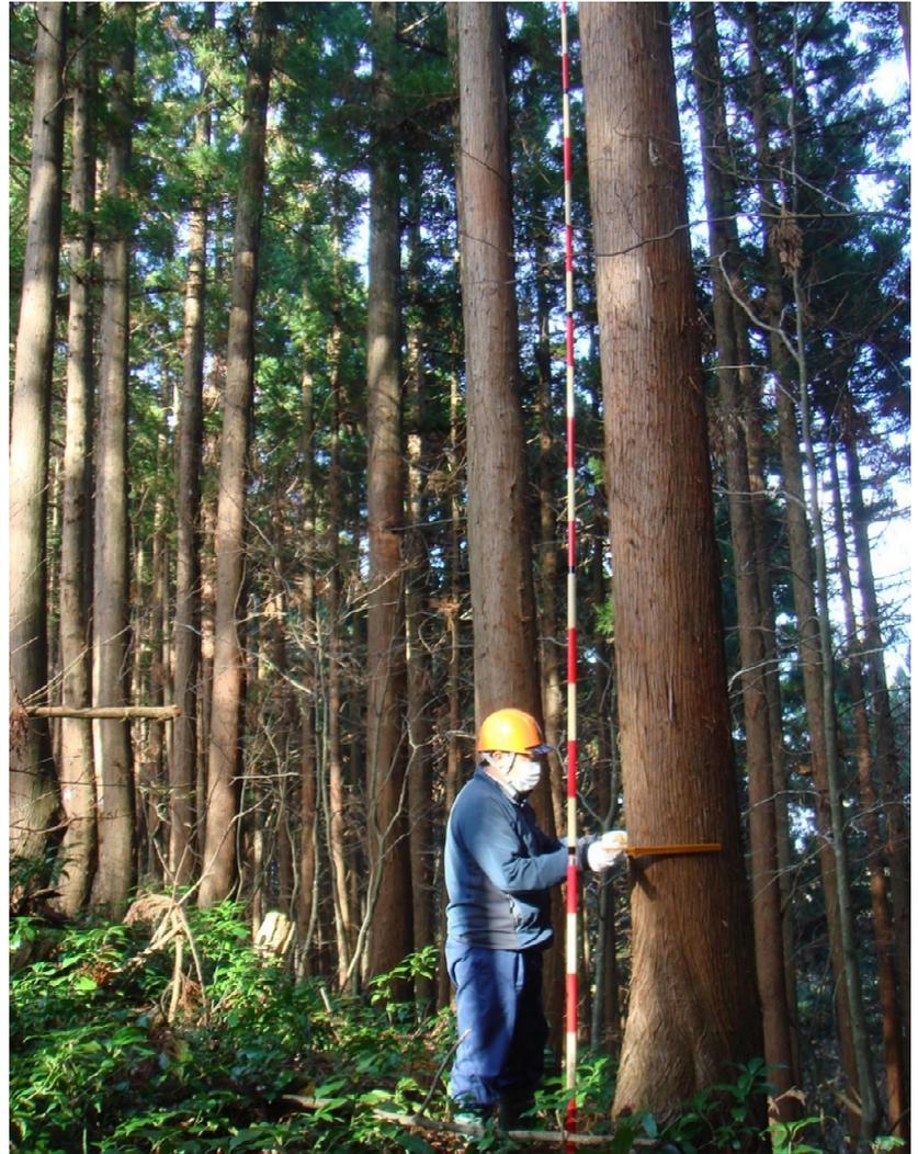
写真の職員が測定しているスギは、樹高24m、胸高直径（地上から1.2mの位置の直径）38cmでした。
