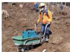
電動クローラ型一輪車等を活用した造林コストの削減 検討会(森林技術・支援センター)
