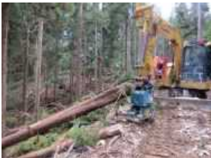
スイングヤーダによる集材作業
