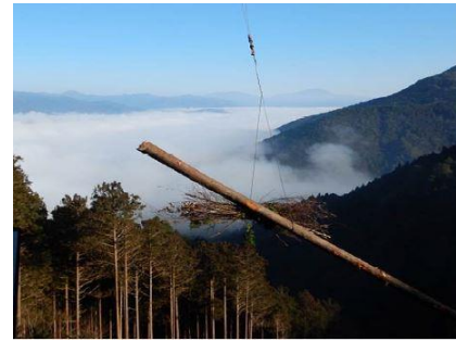
架線による木材と枝条の搬出
