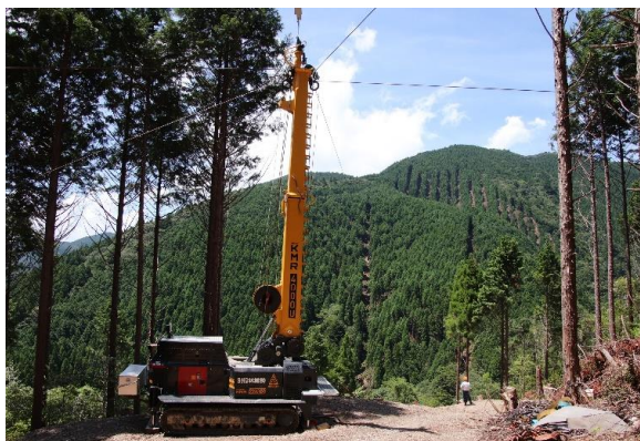
生産事業請負箇所でのタワーヤードによる架線集材
