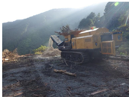
山元土場でのチップーによる末木枝条の破碎
