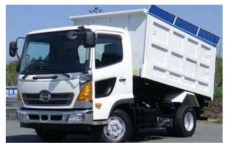
宮野エディションに加えて角底、深箱、強化あおりを付加した機能を有する4WDダンプ 箱型4 t ・ 4 WDダンプ（自称都城エディション）
