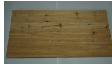
第二世代コウヨウザンの集成材の天板 (点状に見えるのは休眠芽の跡)
