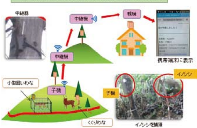
■簡易無線通信を活用したわな捕獲通知システム
