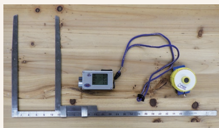
これまでの計測機器 (林尺と測高器 (パーテックス))
