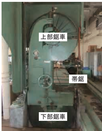
帯鋸盤に帯鋸を掛けた様子
