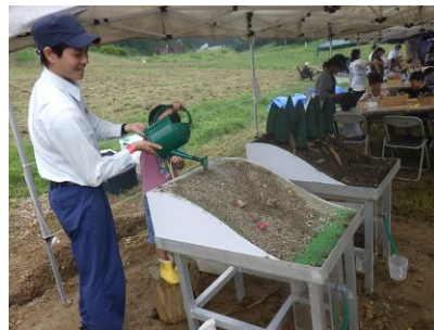
土壌浸透実験の様子
