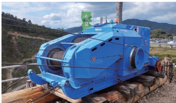
油圧集材機。リモコンによる遠隔操作を行うため無人で稼働する
