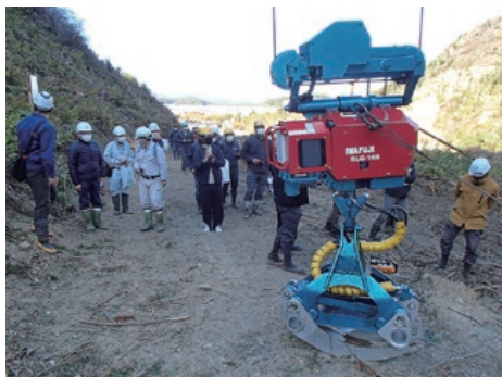
油圧式グラップル。1.6トンの伐倒木を掴んで運搬可能(架線の規格による)
