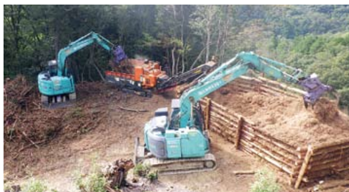
チップパーでチップ化（破砕）されたチップをグラブで整理
