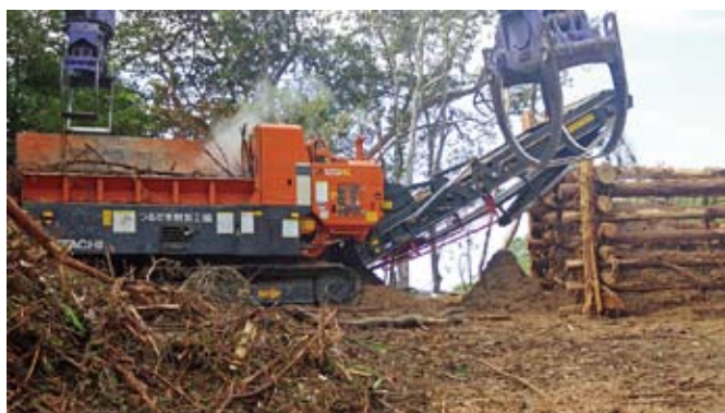
枝条処理する自走式木材破砕機（チップパー）
