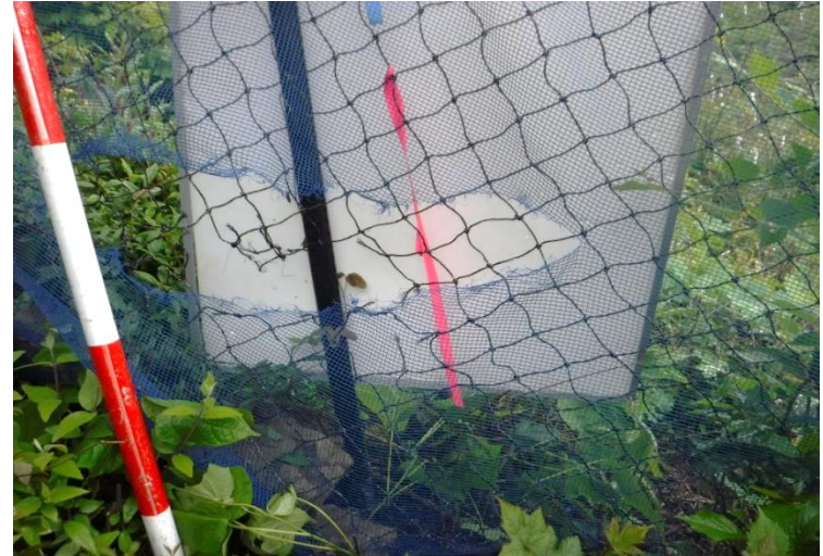
タイプA 本体と防風用ネットの破損
