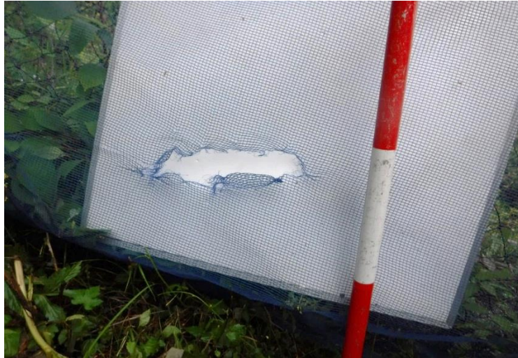
タイプA 防風用ネットの破損
