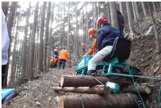
電動集材機操作の様子
