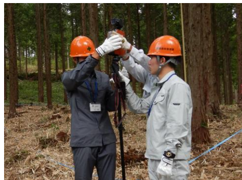
森林3次元計測システムOWLによる森林蓄積の把握実習
