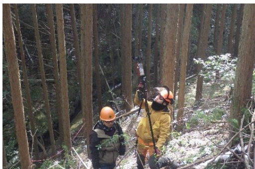
地上型3Dレーザスキャナによる 森林資源量調査
