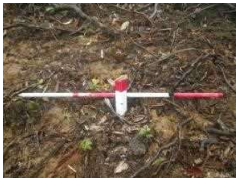
写真1-2. No.1の土砂流出観測杭 (10/27)
