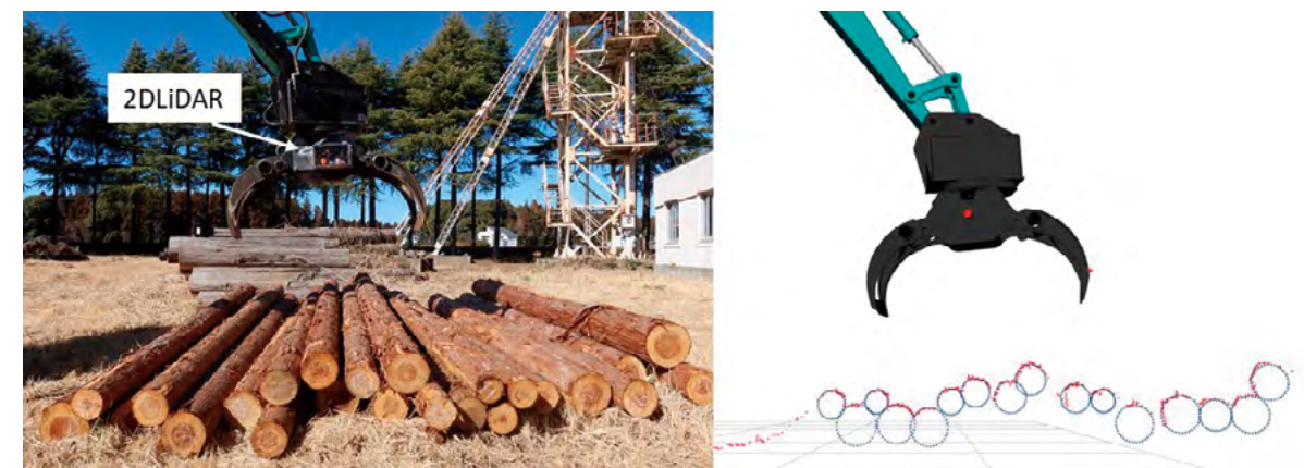
図2 グラップル直下にある丸太の検出
