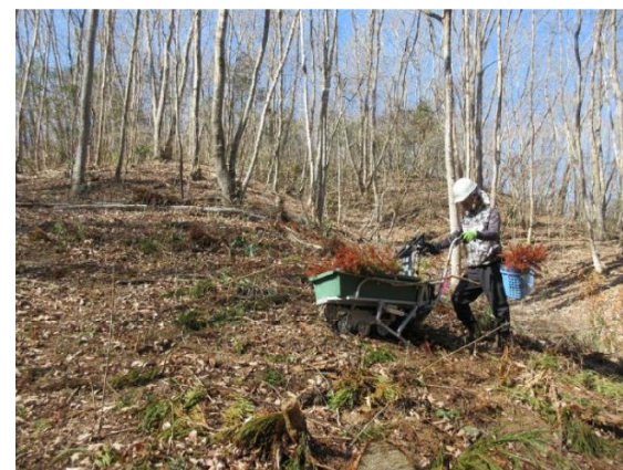
図2 電動クローラ型1輪車による植栽作業
