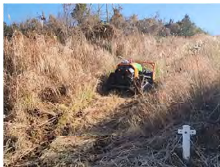
「ラジコン式地拵え機」 下刈り状況
