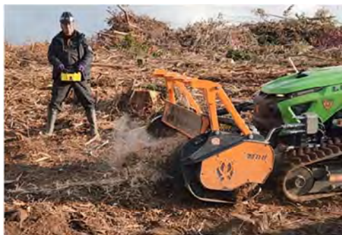
「ラジコン式地拵え機」 根株処理・枝葉破碎状況
