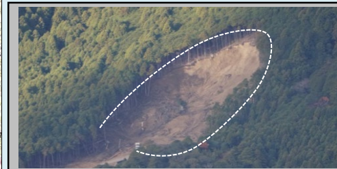
⑤菖蒲谷区域（田辺市本宮町三越） ・崩壊規模 0.90ha ・対策工：溪間工 山腹工 ※事業完了 移管済み
