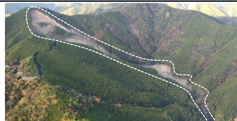
③上平治川区域（田辺市本宮町皆地） ・崩壊規模 6.26ha ・対策工：溪間工 山腹工
