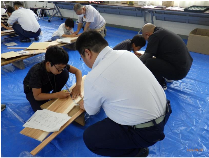
曲尺（かねじゃく）を使って鉛筆で材料に墨入れしています。
