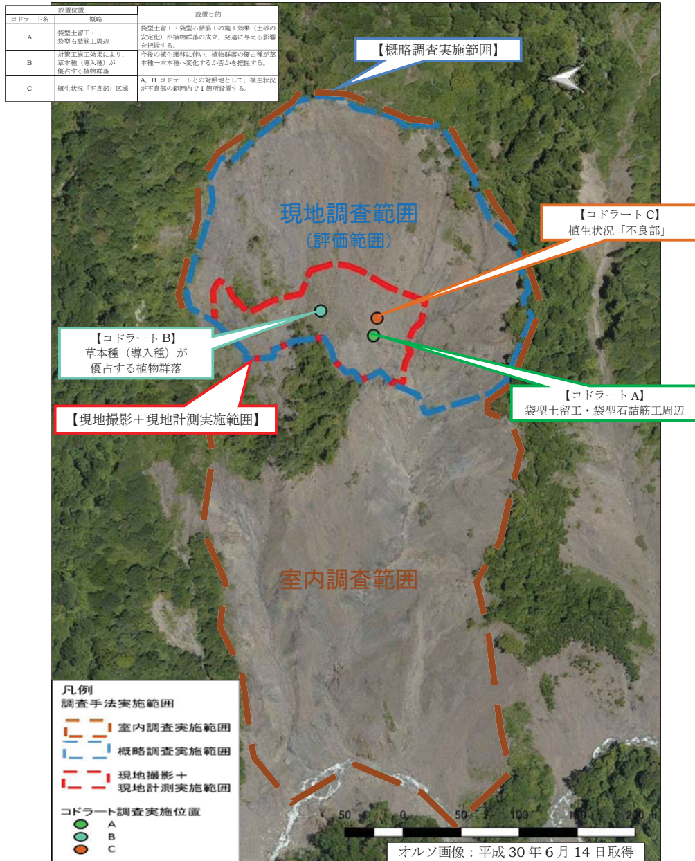
図 2.4 モニタリング実施範囲設定図（2018年度（平成30年度）オルソ画像）
