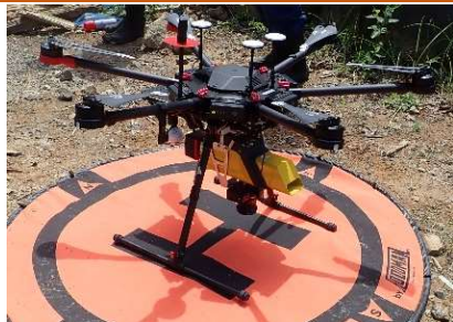
▲測量に使用した UAVレーザー測量機器
