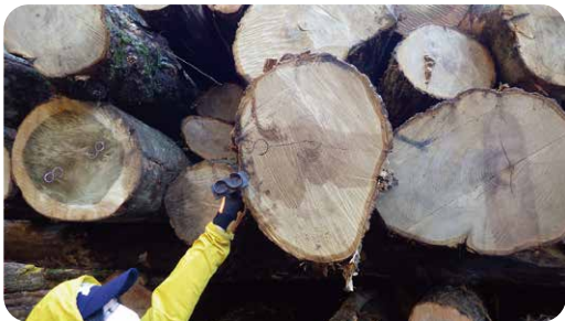
丸太のひび割れ拡大の抑制のため切断面に「S管」を打つ様子。
