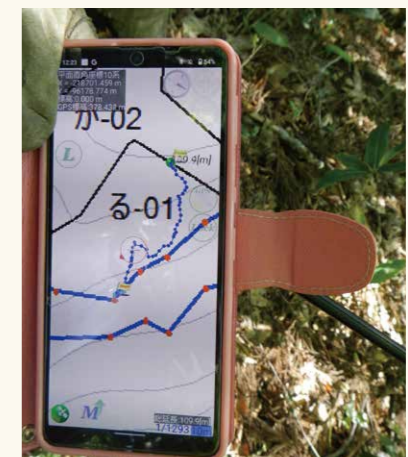
GNSS機器(衛星からの信号を受信して位置情報を取得する装置)。現在地を確認しながら目的地まで道なき道を歩きます。
