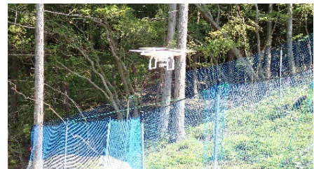
▲ ドローンによる防護柵点検
