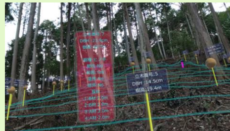
地上レーザスキャナにより解析したデータをスマートグラスにより表示
