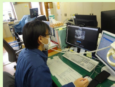
ネットワークカメラ等を活用した遠隔臨場による施工管理
