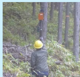
地上レーザースキャナによる計測 地上レーザースキャナによる収穫調査
