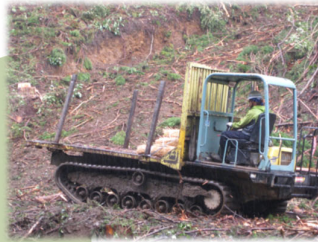
フォワーダによりコンテナ苗等を運搬
