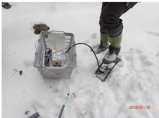
ビンと接続して、ビンの空気を抜く
