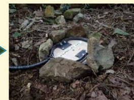
③塩ビ管の上に踏み板をセット
