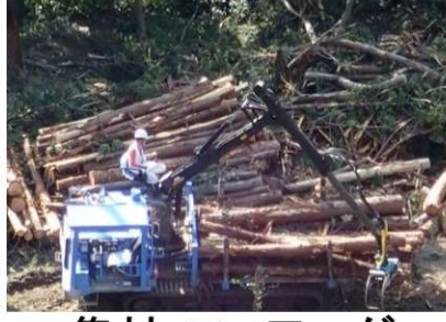
集材：フォワーダ 丸太にした木材を林道に運ぶ
