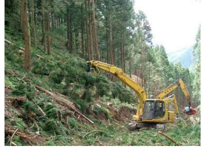
木寄せ：ウインチ付きグラップル 伐倒木を作業道に集める
