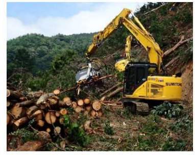
造材：プロセッサ 伐倒木を丸太に切断
